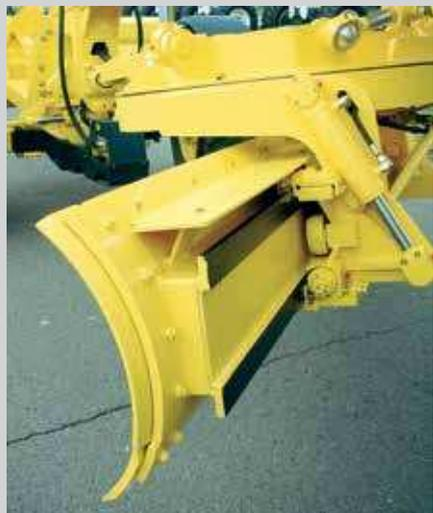
Hydraulische, stufenlose Schnittwinkel-
